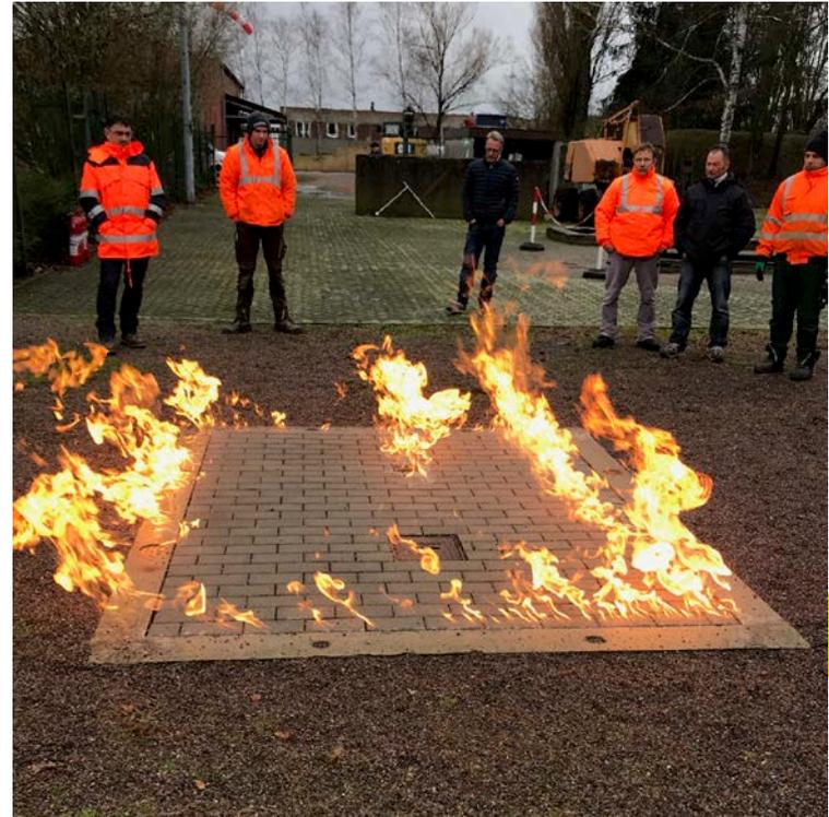
Gepflastert / Undichte Gasleitung mit 500 mbar Druck
