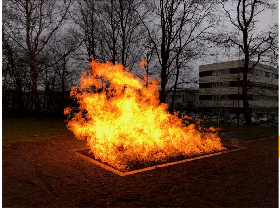
Schotterfläche / Undichte Gasleitung mit 500 mbar Druck
