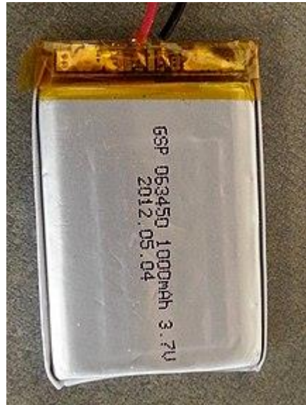
Pouchzelle neu (z. B. Mobiltelefon, Laptop, Modellbau, PKW)
