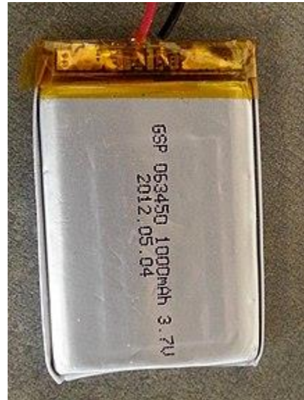
Pouchzelle neu (z. B. Mobiltelefon, Modellbau, PKW)
